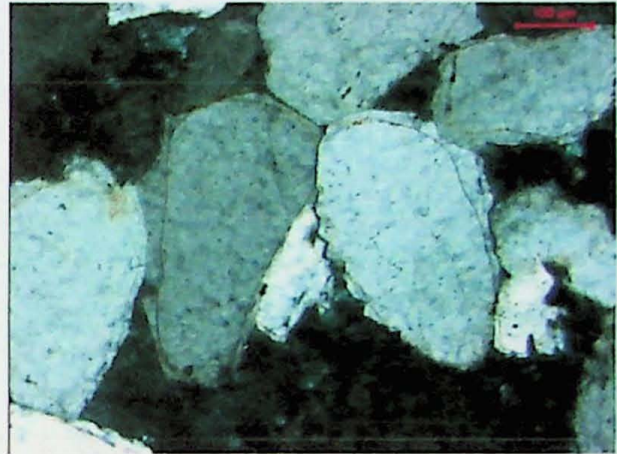
Figura 27 Cimentação syntaxial intensa inibe a compactação química e por isso os contatos entre grãos são pontuais ou planares (centro da foto). Mais comuns são os contatos entre os cimentos OR 100.
