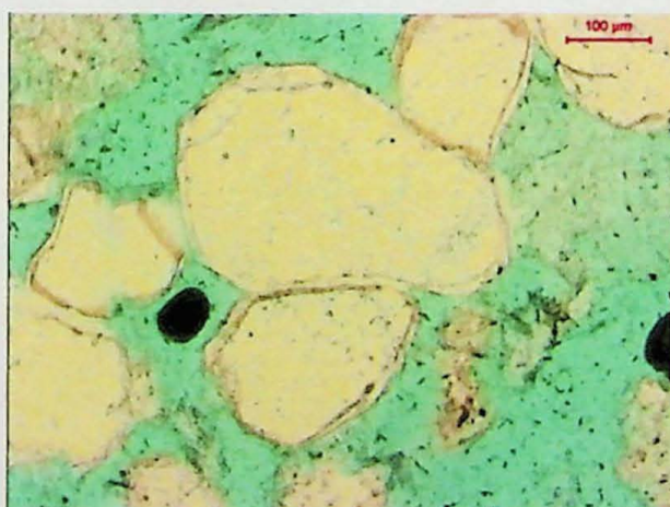
Figura 24 Cimento sintaxial de quartzo, notar o contato entre os cimentos OR 91.
